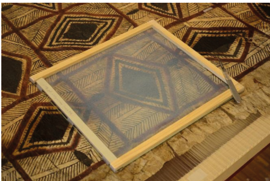
Figure 20 Dispositif pour le découpage du gel d'agar. ©Nicolas Moret, HE-ARC CR, MCAH.
