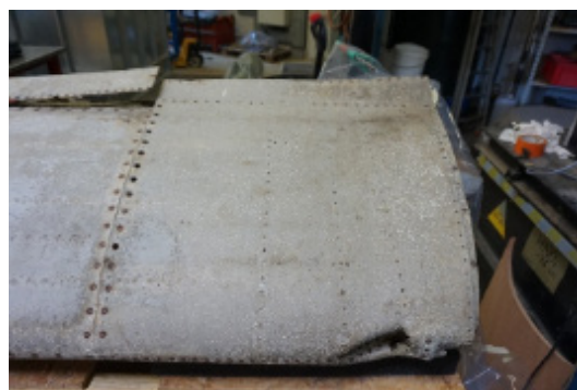
Figure 12 Nettoyage mécanique avant et après traitement (a et b) et consolidation (c); nettoyage chimique avec du TAC 5 % p/v appliqué avec du gel d'agar à 3% p/v par pulvérisation (d); enlèvement de la surface du gel avant le nettoyage (e); surface après le nettoyage (f). © Arc'Antique.
