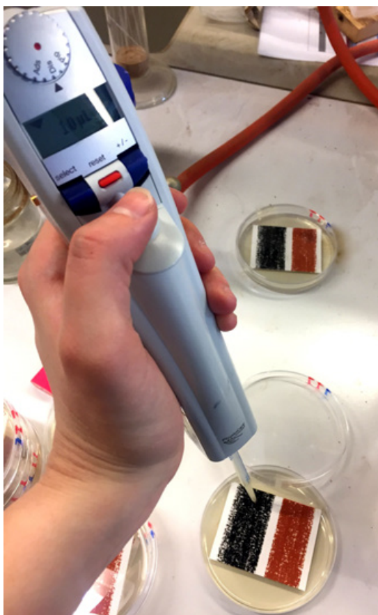
Figure 11 Visuel de l'inoculation des mock-up à l'aide d'une micropipette. © Mathilde Bezon.
