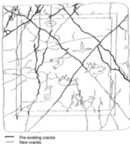
Figure 2 Schéma d'une peinture murale romaine représentant la mort d'Iracus : représentation schématique mettant en avant les fissures apparues durant les travaux, d'après Thickett, 2002, fig. 4, p. 93.
