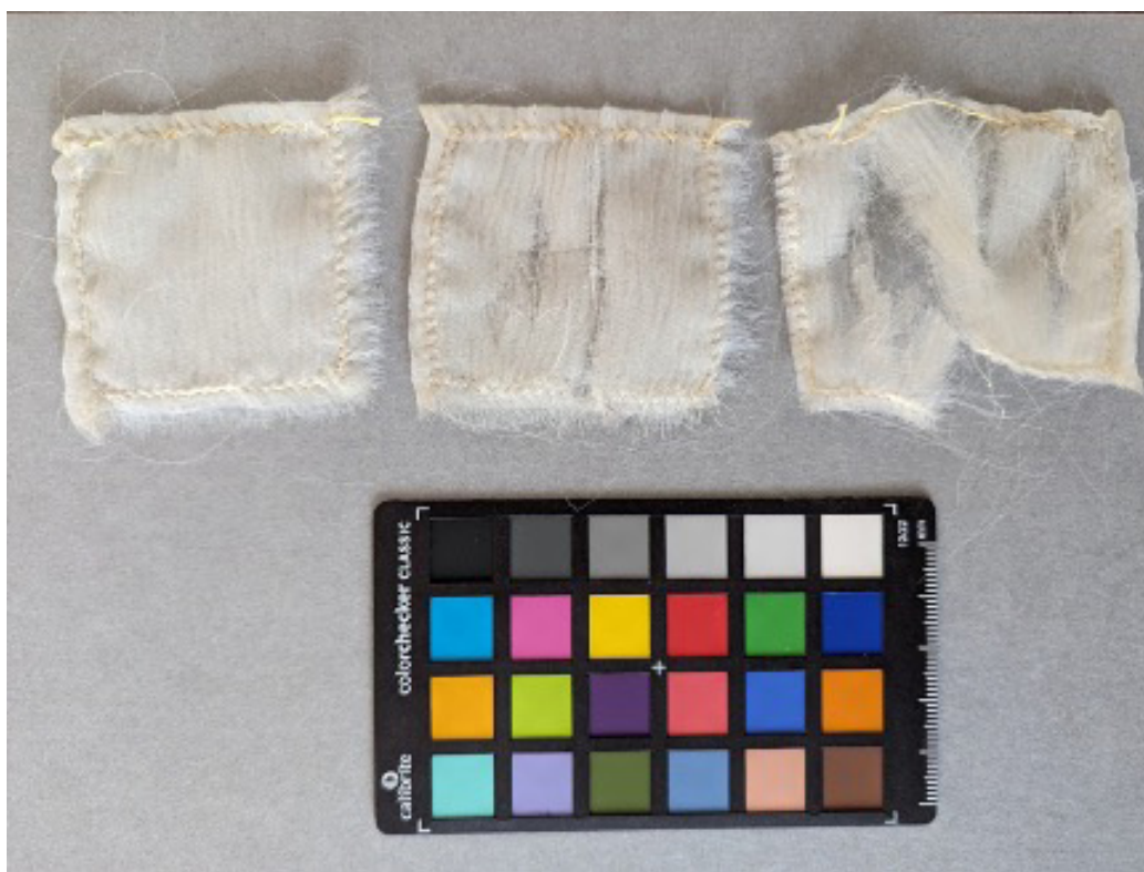
Figure 7 Éprouvettes du lot 1 après vieillissement, de gauche à droite : aucune traction, légère traction manuelle et traction manuelle maximale. © Mylène Ducharme.
