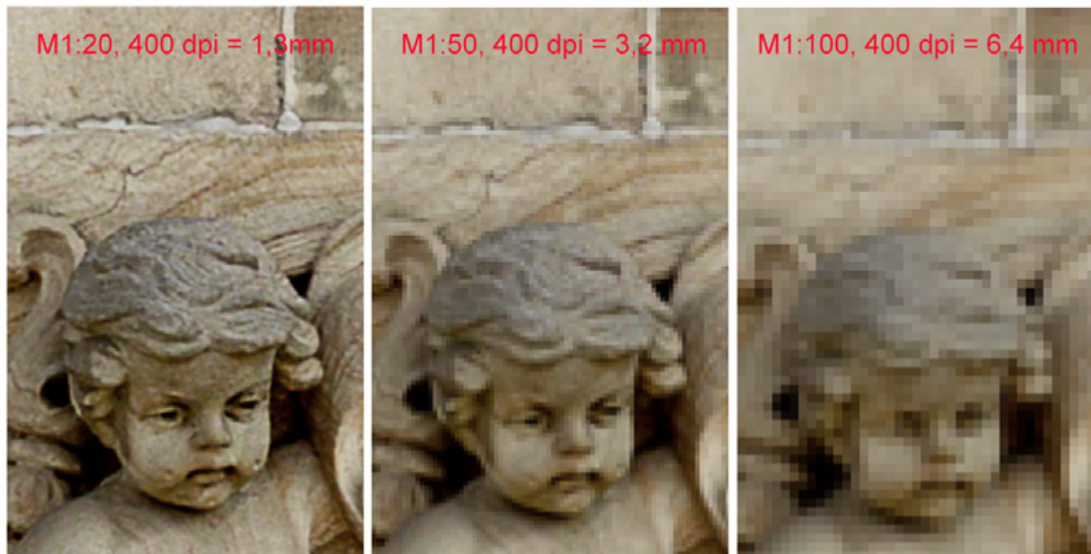
Figure 1 Résolution des détails en fonction de l'échelle de l'image 1:20, 1:50, 1:100 pour une résolution d'image de 400 dpi. © fokus GmbH Leipzig.
