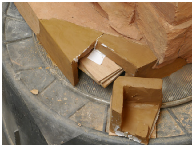
Figure 32 Séparation des trois éléments pour obtenir un séchage homogène. © L. Lefèvre.
