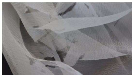
Figure 5 Dégradation de l'étoffe de cigaline sur le prototype. © Mylène Ducharme.
