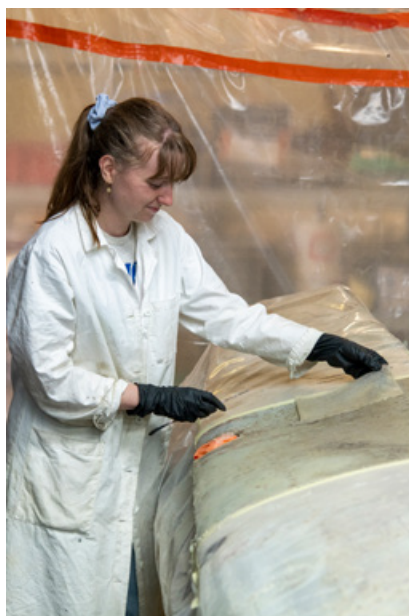
Figure 11 Utilisation d'un gel d'agar par pulvérisation. Le retrait du gel se présente comme un film. © Lisa Preud'homme, Arc'Antique.
