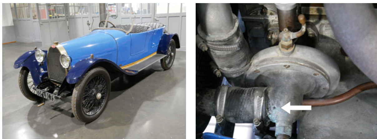
Figure 2 Bugatti Type 30, 1922, MNAM (a) et corrosion localisée d'une pipe du système de refroidissement (b). © E. Granget - HE-Arc CR.
