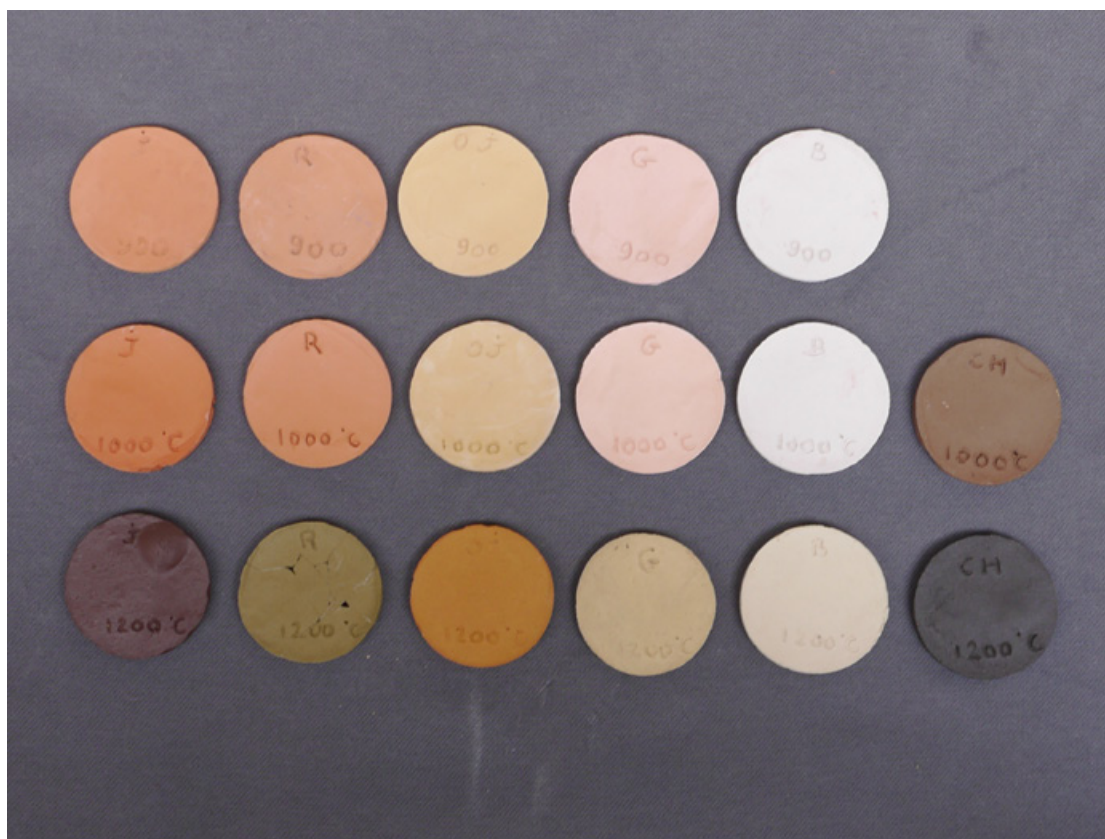
Figure 39 Variation de la couleur de la terre en fonction de la température. © L. Lefèvre.
