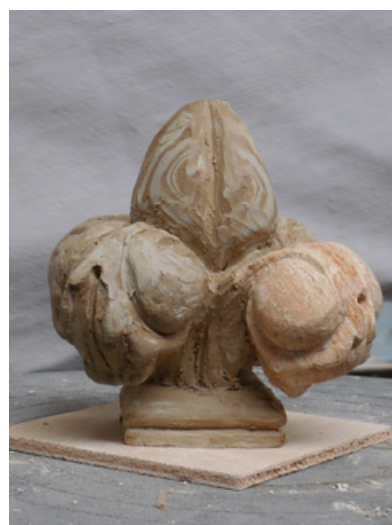
Figure 12 À partir d'un crochet en pierre subsistant, restitution du fleuron en terres mêlées. © L. Lefèvre.
