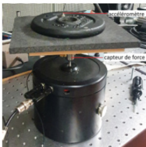
Figure 6 Dispositif expérimental simulant la mise en vibration d'un support et mesurant le niveau de vibration du support et de l'objet.
