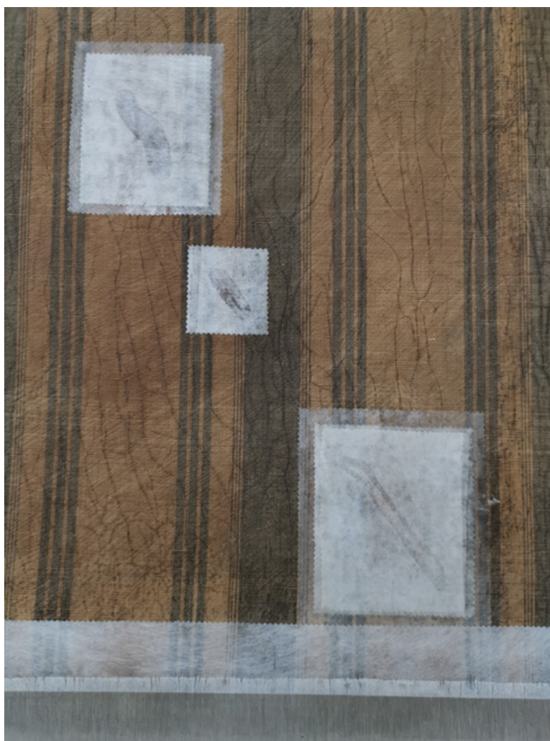
Figure 3 Systèmes de doubles pièces de renfort en intissé polyester sur monofilament de polyester. © Marie-Noëlle Laurent.
