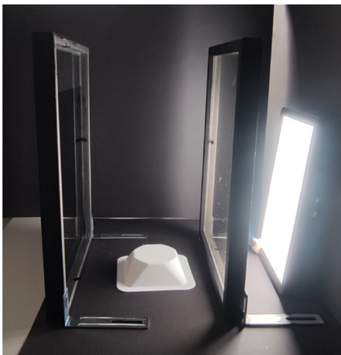
Figure 2 Polariscope construit pour cette étude. La source lumineuse est à l'arrière, le flacon observé est placé entre les deux filtres. © Ash Dupuis / Haute-École Arc / Museum Vrolik.
