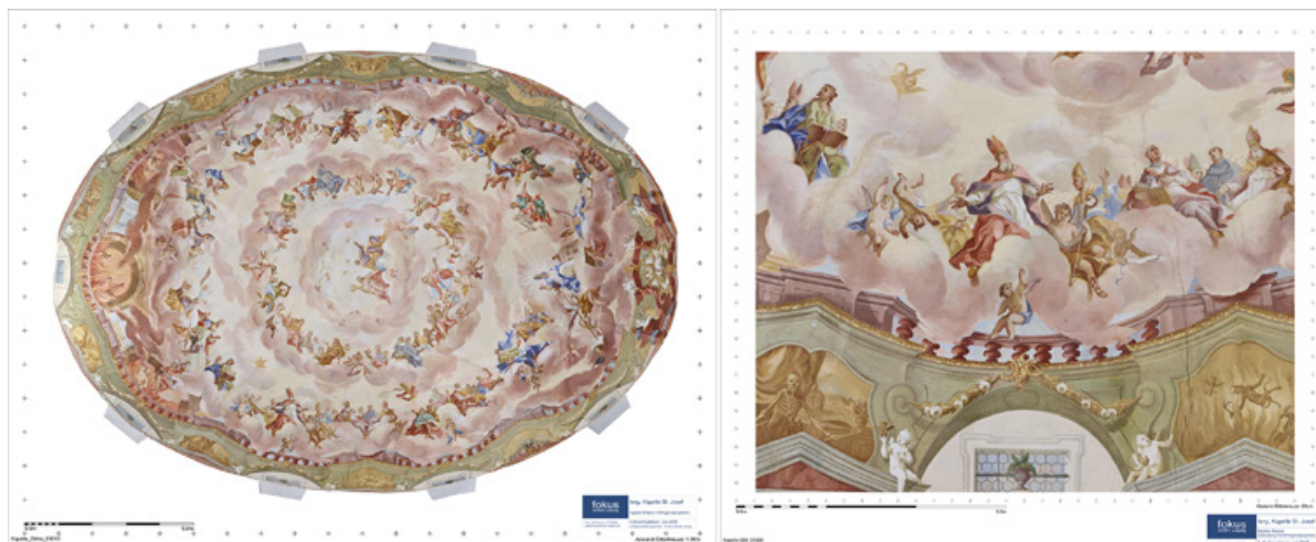
Figure 8 Plans de l'image fidèle à l'échelle originale traitée à l'échelle 1:5 pour 300dpi : projection orthogonale du plafond, à gauche; déroulement combiné à la projection orthogonale, à droite.
