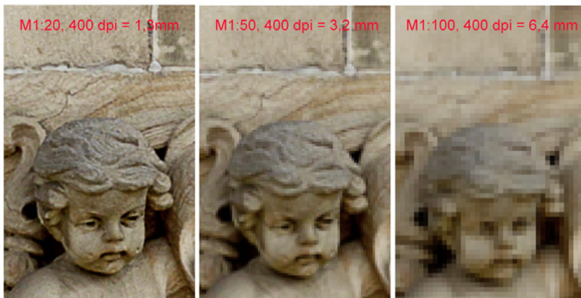
Figure 1 Résolution des détails en fonction de l'échelle de l'image 1:20, 1:50, 1:100 pour une résolution d'image de 400 dpi. © fokus GmbH Leipzig.
