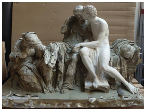
**Figure 22** Nettoyage du plâtre par gel pelable et photoablation. © L. Lefèvre.
