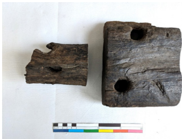
Figure 2 Exemple d'aide tactile à la formation : le même fragment de bois gorgé d'eau a été scié en deux et l'une des moitiés a été traitée au polyéthylène glycol puis lyophilisée, l'autre séchée à l'air libre. © Lucie Altenburg.
