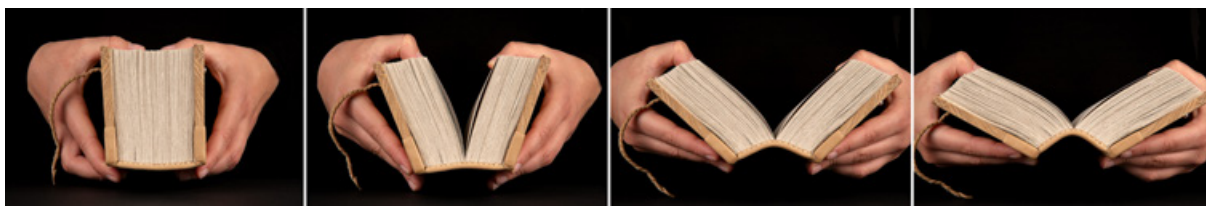
Figure 1 Comportement à l'ouverture d'une structure à dos collé avec déformation concave du dos. Maquette d'une reliure gothique réalisée par Lise Marandet, atelier de conservation-restauration, service de Coopération documentaire interuniversitaire, université Paul Valéry Montpellier 3. © Benjamin Sandri, atelier de photographie, service de Coopération documentaire interuniversitaire, université Paul Valéry Montpellier 3.
