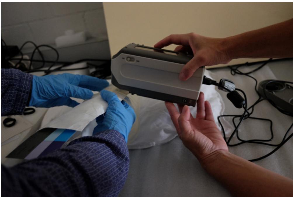
Figure 4 Mesures de couleur sur l'un des tirages en Bioresin® à l'aide du spectrophotomètre Konica Minolta CM 2600 d, réalisées au Centre des collections du Musée national suisse © Service archéologique du canton de Berne.
