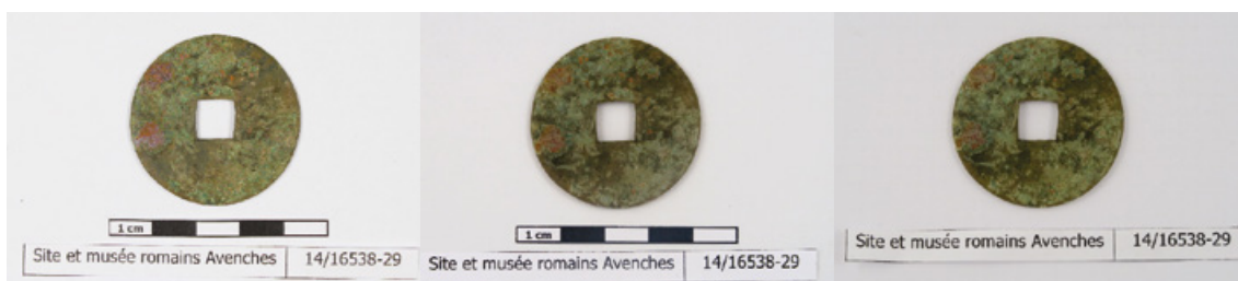
Figure 5 Objet archéologique romain 14/16538-29. De gauche à droite : avant traitement, après traitement, après vieillissement accéléré. © N. Gutknecht, He Arc, 2018.
