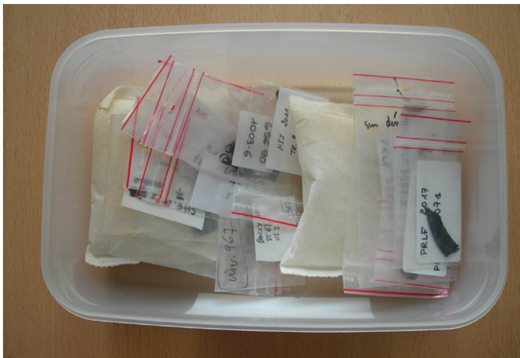
Figure 8 Boîte pour des métaux avec sachets de gels de silice. © Silvia Pain / EPI 78-92.
