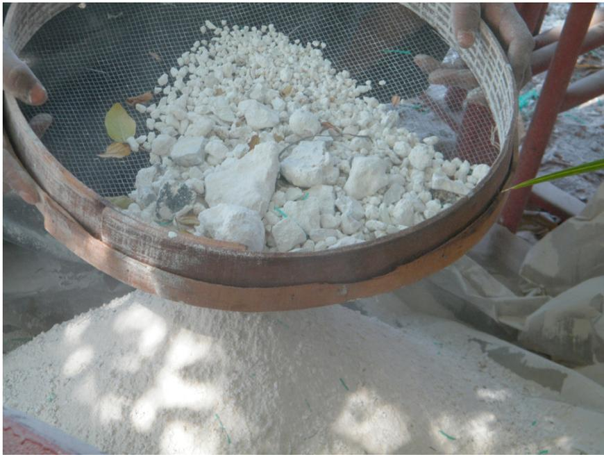
**Figure 7** Tamisage de la chaux locale pour éliminer les incuits.
