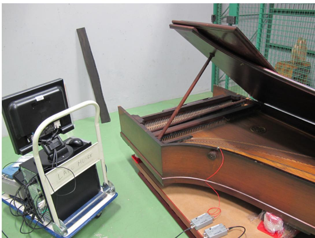
**Figure 6** Enregistrement sur un clavecin suspecté d'être infesté par des xylophages avec le système ATAX<sup>®</sup>. © Cité de la musique-Philharmonie de Paris.
