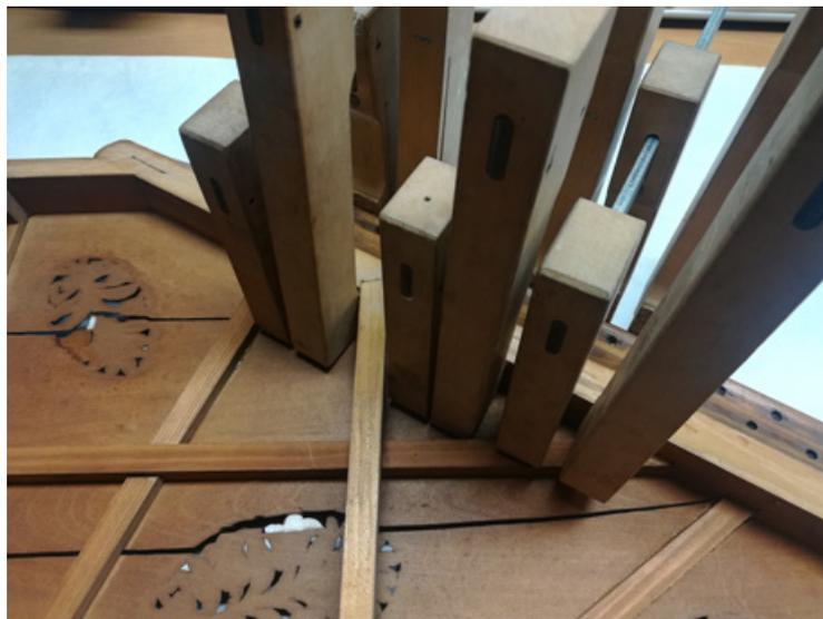
**Figure 14** Collage du chevillier fendu après dépose de la planche de fond. © Esther Jorel.
