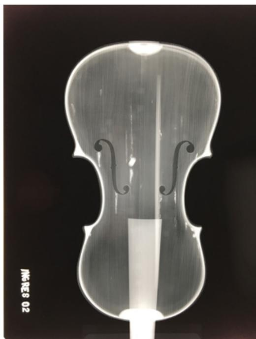
Elle consiste à obtenir une image générée par le contraste entre le passage et l'absorption de rayons X projetés sur un objet. Elle permet de visualiser sa structure interne et de mettre en évidence son état de conservation. Les informations obtenues concernent aussi bien la recherche d'éléments liés à la technique de fabrication et l'identification de différentes phases d'élaboration successives que la détection de zones de restauration ou encore de zones de faiblesse (fig. 5).
