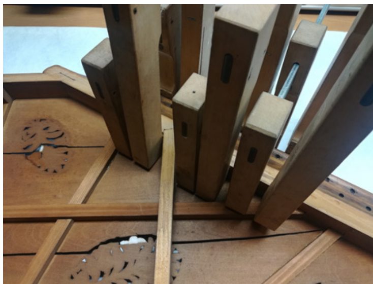
Figure 14 Collage du chevillier fendu après dépose de la planche de fond. © Esther Jorel.
