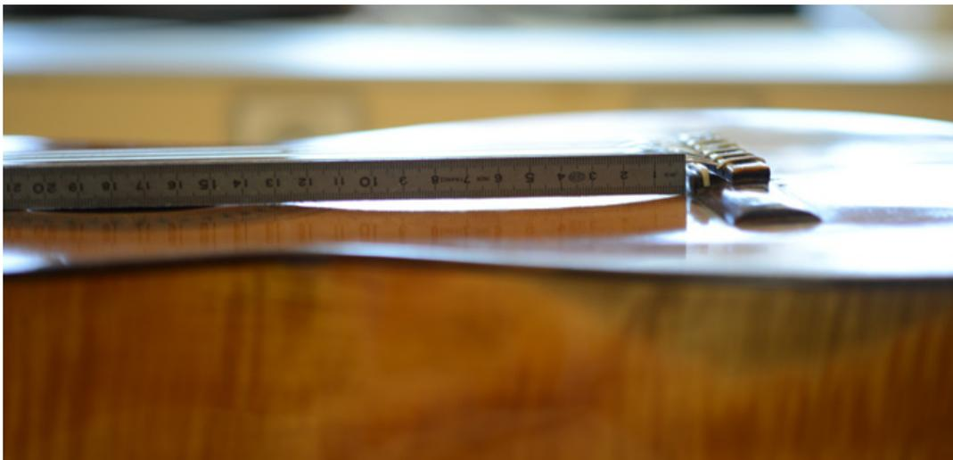
**Figure 4** Mesure longitudinale des contraintes mécaniques imposées à la table d'harmonie avec les cordes sous tension. © Emeline Chevalier.
