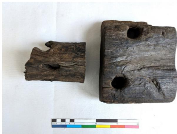
**Figure 2** Exemple d'aide tactile à la formation : le même fragment de bois gorgé d'eau a été scié en deux et l'une des moitiés a été traitée au polyéthylène glycol puis lyophilisée, l'autre séchée à l'air libre. © Lucie Altenburg.
