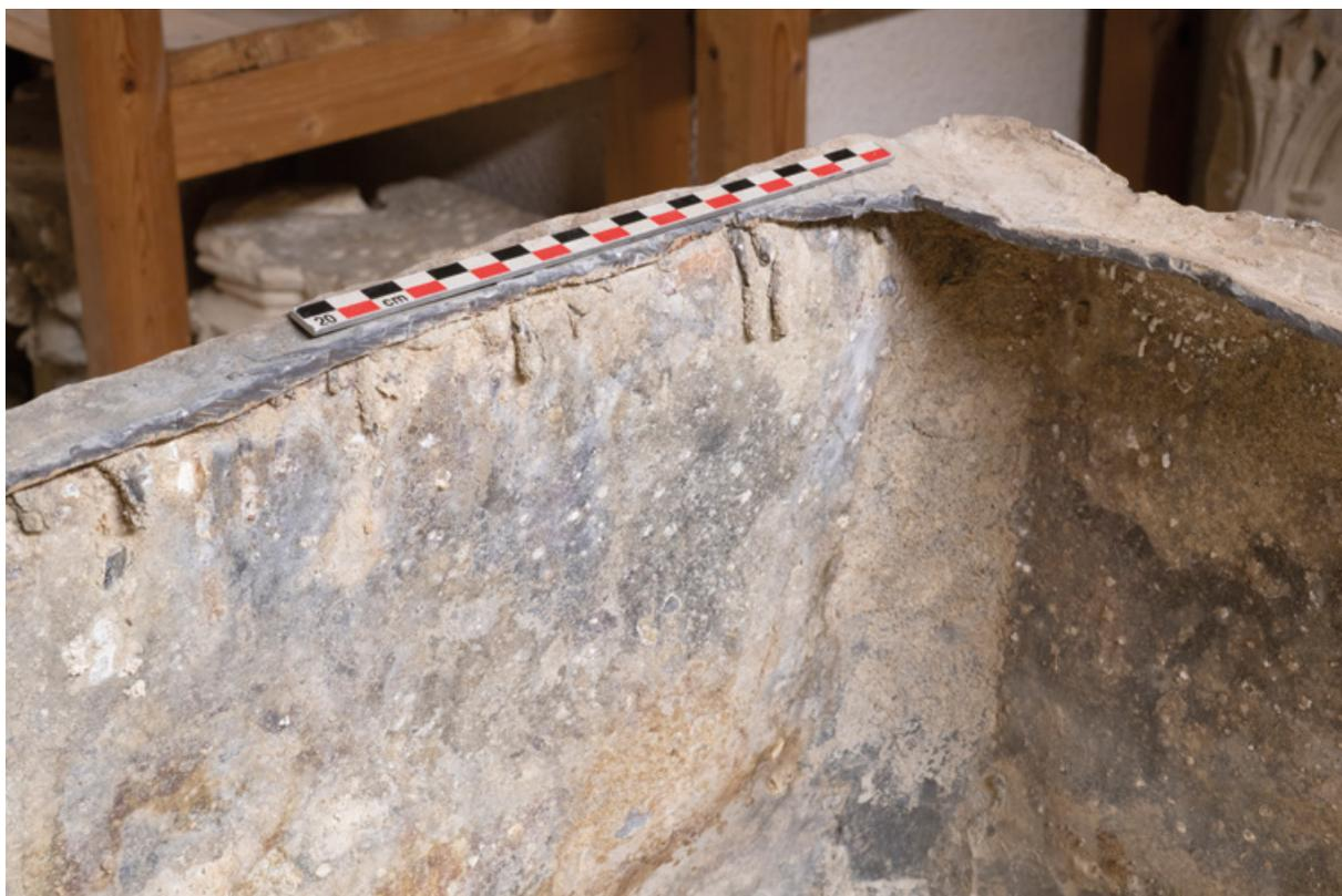
**Figure 9** Vue interne de la partie A où des coulures de l'alliage de brasure se sont solidifiées pendant le brasage de la voûte. (cl. Gauthier, L., Ville de Bordeaux).
