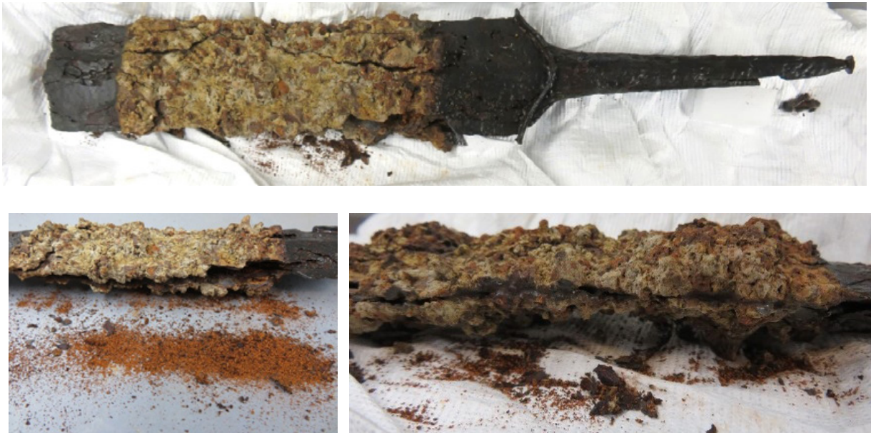
Figure 20 Aperçu d'un objet partiellement nettoyé présentant des reprises de corrosion différentielles. © A-CORROS.
