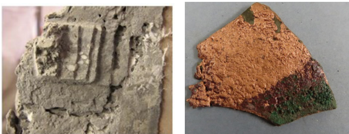
Figure 5 Vue macroscopique des strates dégagées lors d'un nettoyage de produits de corrosion sur un objet archéologique; à gauche: en fer (paroi de coffre romain composite, contexte subaquatique, MDAA, Arles); à droite: en alliage cuivreux (élément de miroir, contexte terrestre, Ville d'Aix en Provence), © A-CORROS.
