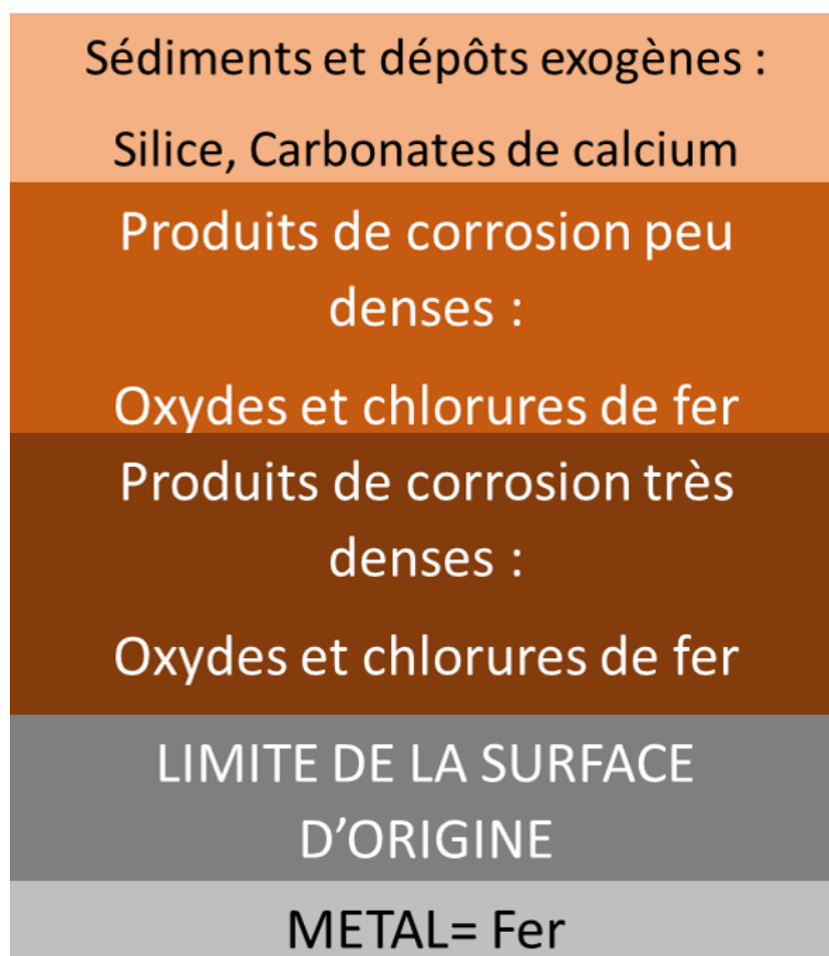
Figure 9 Représentation schématique de la stratigraphie d'un objet archéologique métallique en fer © A-CORROS.
