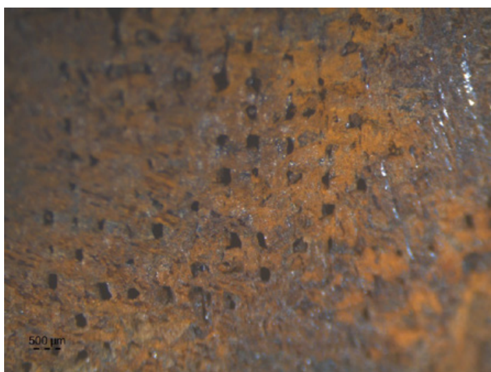
Figure 18 Fragments abrasés d'un umbo en fer (musée d'Enserune) ayant connu une ancienne restauration; traces de fraise, éléments techniques illisibles (torsion, diamètre des fils) mais conservation de la lecture de l'armure et de la disposition du fragment. © A-CORROS.
