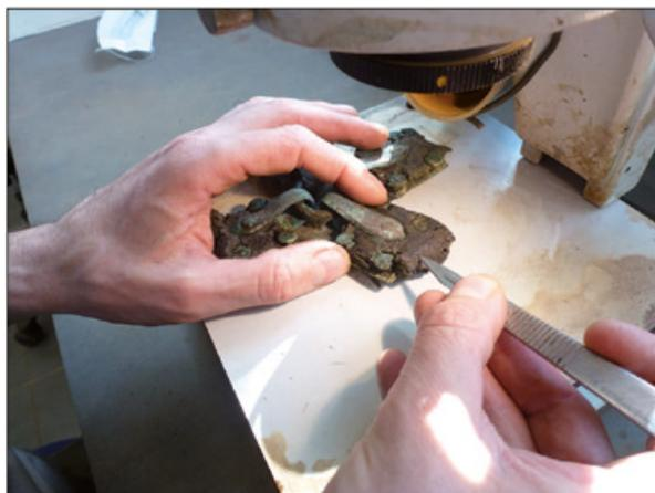
**Figure 14** Nettoyage au scalpel, sous loupe binoculaire, du revers de la croupière.
