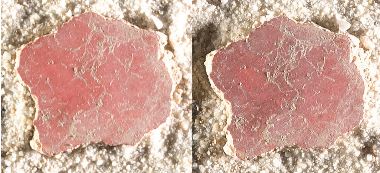
Figure 12 Sous le filtre interférentiel laissant passer la longueur d'onde de 580 nanomètre (dans la zone du spectre vert-jaune), le fragment d'enduit peint présente rapidement, de façon très nette, une évolution colorimétrique vers le noircissement. © A. Martin, ACRM-MDAA.
