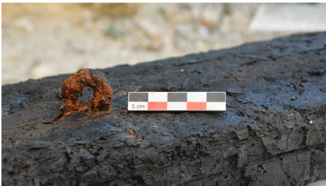
Figure 17 Piton en alliage ferreux fiché dans une poutre calcinée. Il paraît stable. © E. Bouilly.
