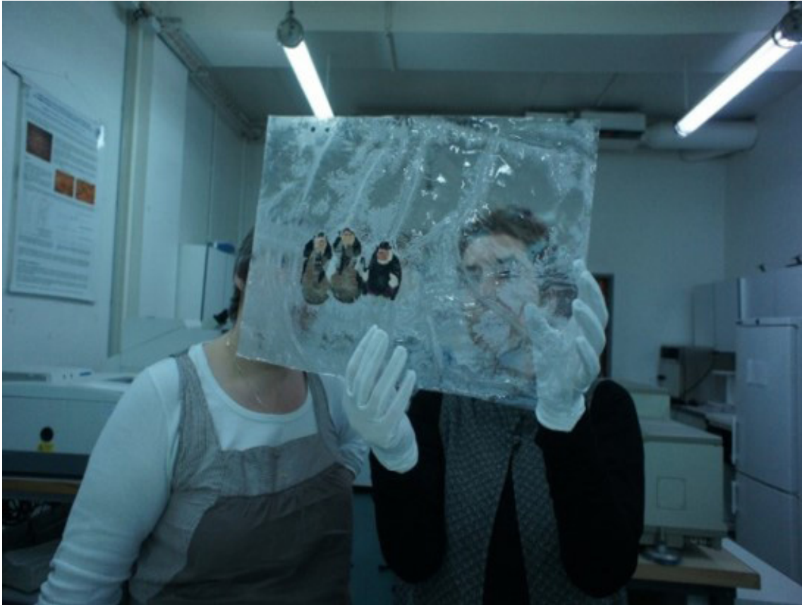
Figure 3 Efflorescence et opacification sur un celluloid d'animation. © Françoise Lémerige.
