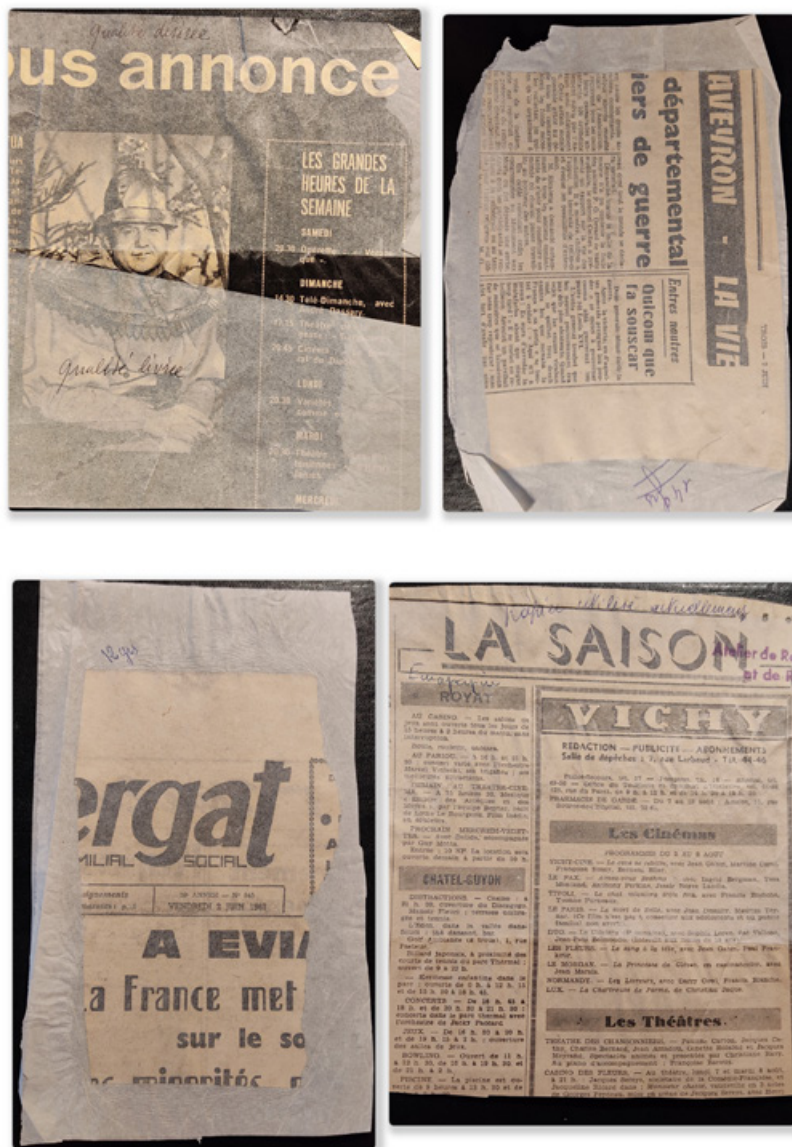
Figure 11 Tests et comparatifs de papiers de doublage. En haut : qualité de papier désirée et papier reçu (gauche), doublage avec un papier mousseline 14 g. En bas : doublage papier mousseline 12 g (gauche), comparatif de deux qualités de papier mousseline pour doublage, 1959, Europapier. © Emilie Arnaud-Nguyêñ.
