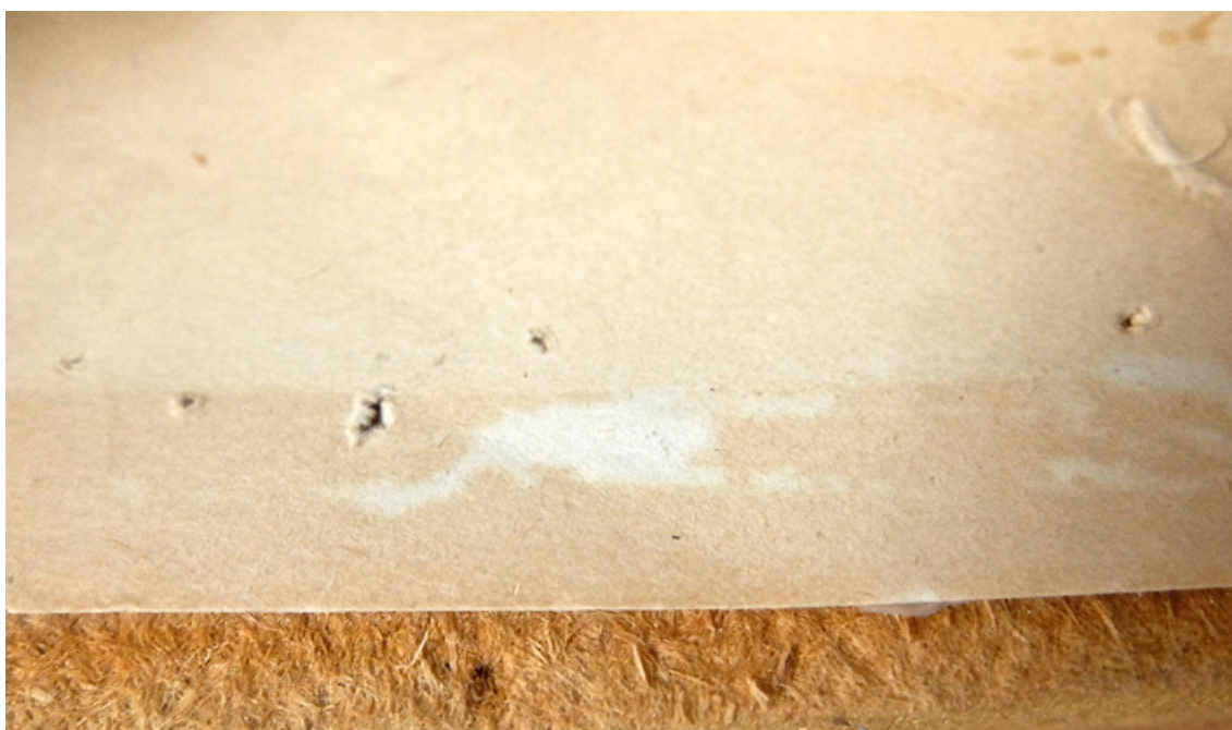
Figure 4 Jaunissement hétérogène d'un papier Color-Aid sans couchage : tache plus claire au niveau des zones de collage et marque (horizontale) produite par la présence d'un papier au-dessus, protégeant de la lumière. © Lucie Bibal.
