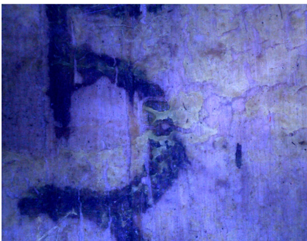
Figure 21 Détail des résidus de la colle d'entoilage (UMC 10 – face B) sous UV. Dino-Lite , x 50. © Solène Girard.
