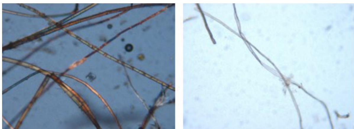
**Figure 11** Observation au microscope optique des prélèvements de *Juicio sobre monedas y alcavalas* avec réactif Herzberg. À gauche : en lumière polarisée MS.x100 (fibres de lin et de chanvre et grain de silice). À droite : en lumière polarisée Ms.x100 (fibres de coton). © Justine Faucon, IAPH.
