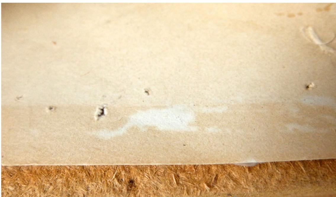
**Figure 4** Jaunissement hétérogène d'un papier Color-Aid sans couchage : tache plus claire au niveau des zones de collage et marque (horizontale) produite par la présence d'un papier au-dessus, protégeant de la lumière. © Lucie Bibal.
