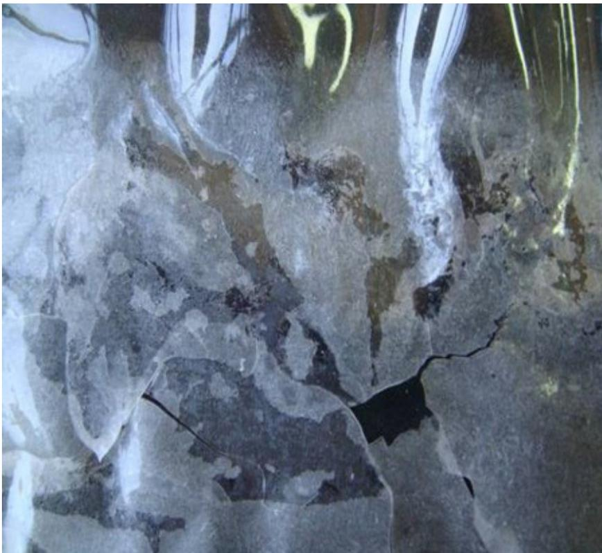
**Figure 4** Cassure du support plastique d'un celluloid d'animation.
