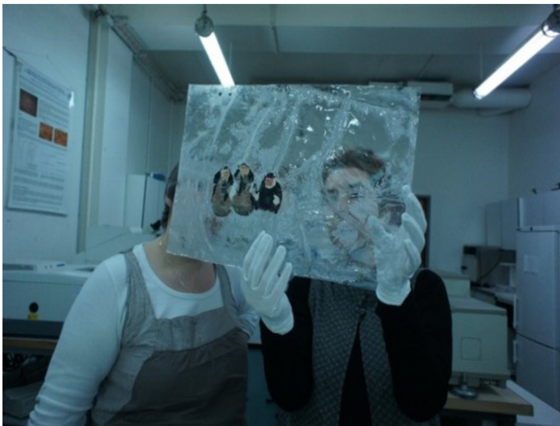
Figure 3 Efflorescence et opacification sur un celluloïd d'animation. © Françoise Lémerige.
