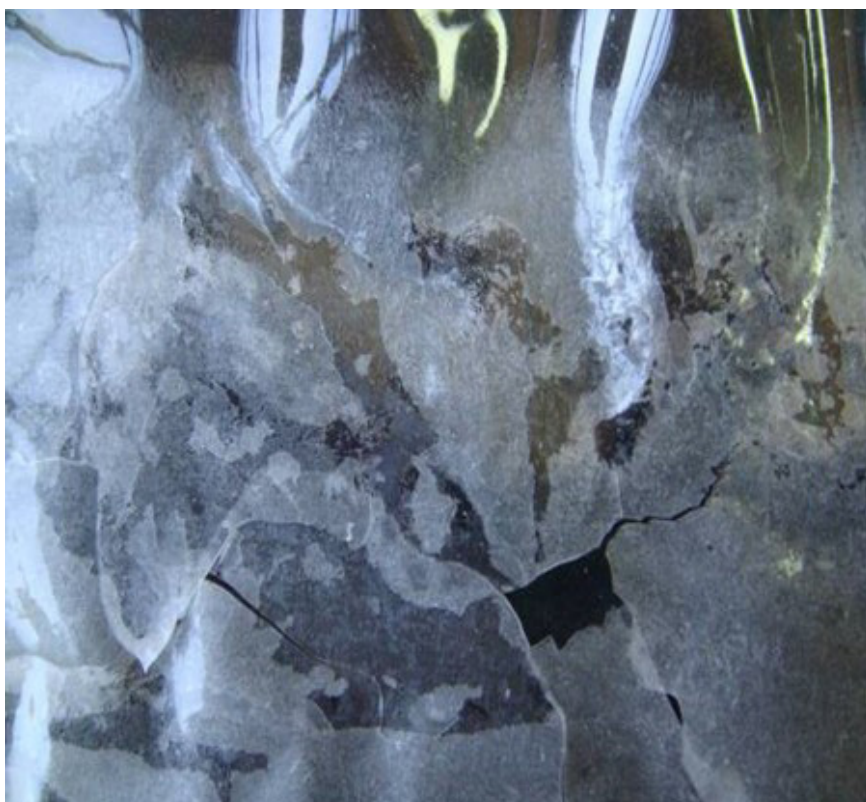
Figure 4 Cassure du support plastique d'un celluloïd d'animation. © Françoise Lémerige.
