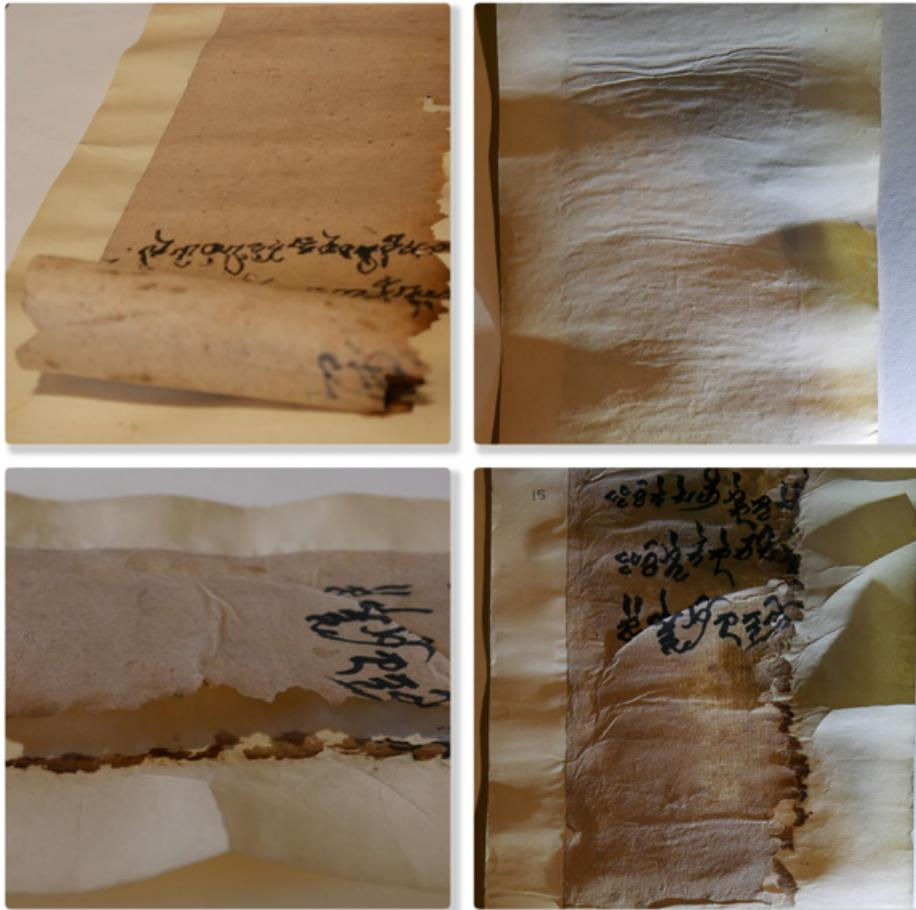
**Figure 18** En haut : PK DAM 507 15, la feuille est partiellement détachée du papier de doublage (gauche); PK DAM 507 21, le document gondole, il est parcouru de plis (droite). En bas : PK DAM 22 le papier se détache de son support, il est parcouru de plis, il se déchire et il gondole (gauche et droite). © Emilie Arnaud-Nguyên.
