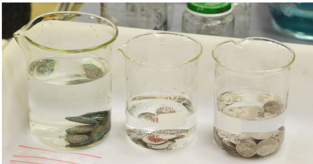
Figure 9 Bains de traitement des deniers d'argent : « sel de Rochelle », acide formique, rinçage. © Florent Duval, CREAM.
