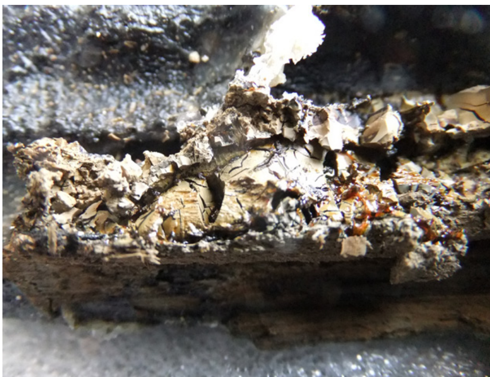
Figure 3 Consolidation hétérogène à cœur. © ARC-Nucléart.
