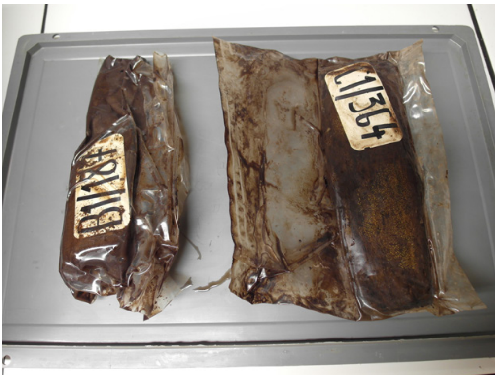
Figure 12 Le placage des sachets plastiques sur les ex-voto a engendré des déformations des bois. © ARC-Nucléart.
