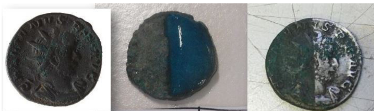
Figure 5 Exemple de traitement de nettoyage chimique par gel, mené sur une pièce en alliage cuivreux avec une argenture (traitement d'EDTA pendant 2 h avec un gel d'agar). © Elodie Guilminot / Arc'Antique.
