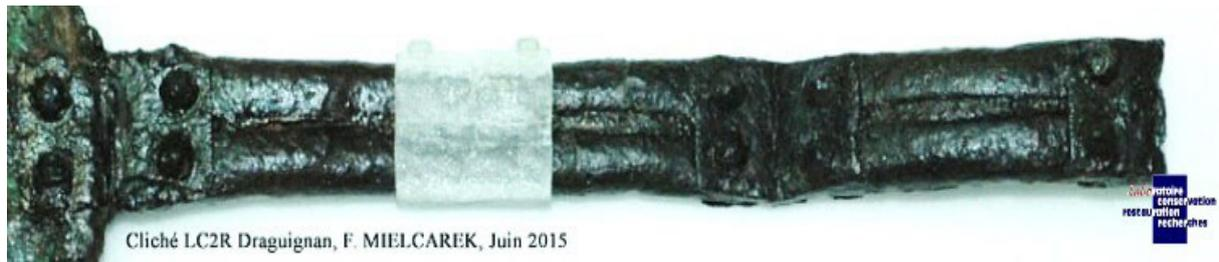
**Figure 23** Résultat final obtenu après positionnement de la gaine (avers). © LC2R Draguignan.
