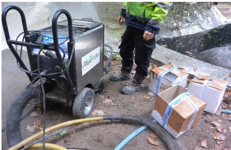
**Figure 10** *Le Cyclope*, Jean Tinguely et Niki de Saint-Phalle, Milly-la-Forêt. Cryogénie avec ou sans abrasif : décapage par projection de pastilles de CO<sub>2</sub>. ©A-Corros.
