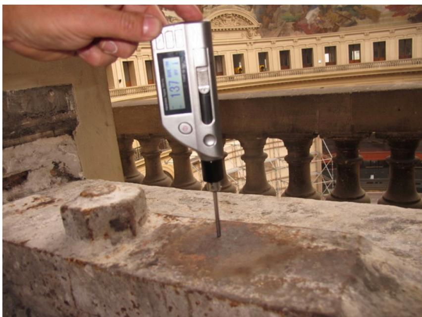
**Figure 3** Paris, coupole en fonte de la Bourse du Commerce. Mesure de dureté sur une zone décapée. ©A-Corros.
