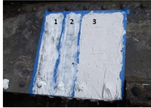
**Figure 4 (a, b)** Paris, gare d'Austerlitz, grande halle des voyageurs. Essais de décapage au gel chimique (caustique) sur chéneau déposé : application des trois solutions Dumond Chemicals®. ©A-Corros.
