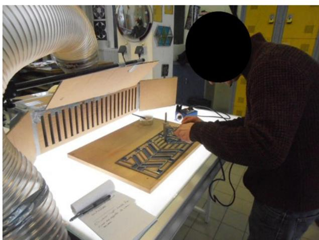
**Figure 2** Essai d'aspiration des fumées de soudage
