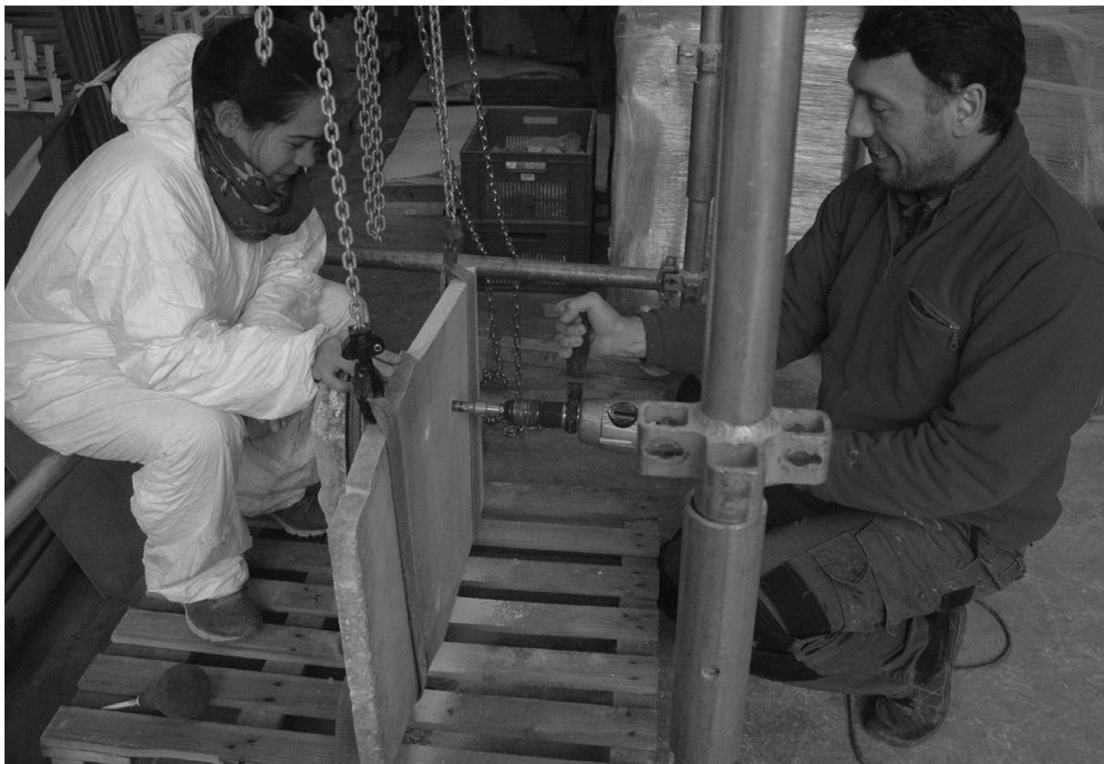
**Figure 1** Carottage d'un goujon liant un fragment antique à une plaque de fond moderne: exemple de collaboration. © E. Desroches.
