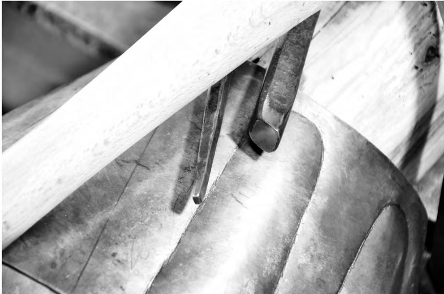
**Figure 13** Détail des outils, avec un percuteur en bois pour bomber le métal.
