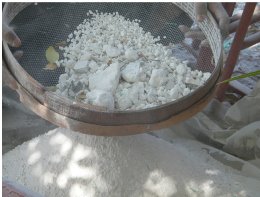
Figure 7 Tamisage de la chaux locale pour éliminer les incuits. © CFEETK, L. Pieri.
