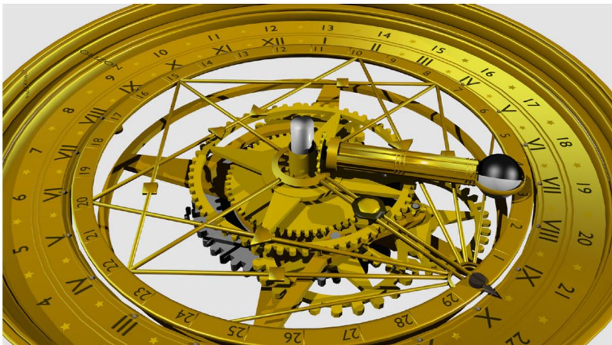
**Figure 7** Image tirée de la modélisation 3D de l'horloge permettant de dévoiler une partie du mécanisme des complications astronomiques © Emmanuel Aguila.
