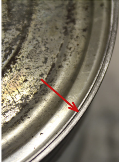
Figure 6 Ligne de séparation de la tôle supérieure du serti après abrasion – boîte de quenelles au Madère appartenant au Museum Burghalde de Lenzburg. © HE-Arc 2017
